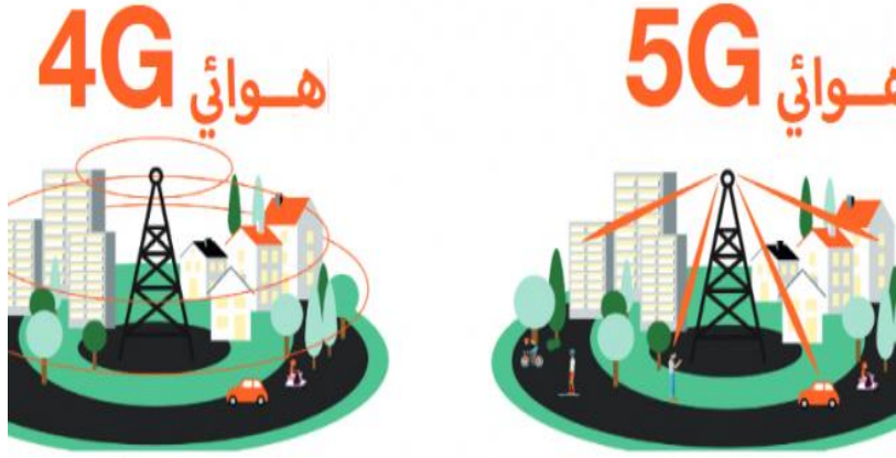
الشكل (2) يوضح الفرق بين موجات الراديو في هوائيات الجيل الخامس والرابع [12]
